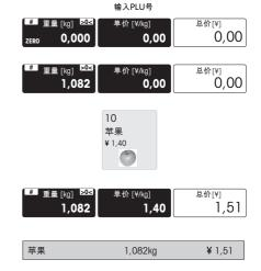
如果您想锁定 PLU 以用于进一步称重,触摸单价字段左侧并启用"锁定选项"功能。在启用该功能时,锁定 (FIX) 符号将显示在单价字段的左下角。
